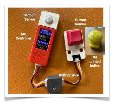
IOT CONTROLLER (M5) WITH MOTION SENSOR AND TOUCH BUTTON PHYSICALLY CONNECTED WITH GROVE WIRES. DISPLAY HAS LIMITED SPACE. 3D BUTTON WRAPS RED BUTTON FOR EASIER TOUCH.
